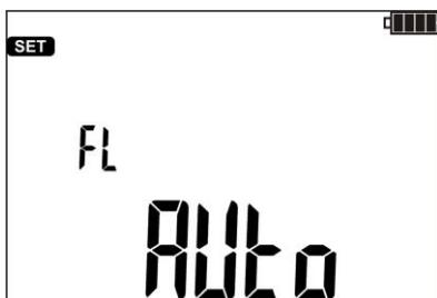
Měřič MIC-5001 obsahuje analogový filtr, který tlumí střídavé složky proudu a umožňuje měření v prostředí silného elektromagnetického rušení. Aktivace filtru FL způsobí mírné prodloužení času nutného ke stabilizaci provedených měření. Měřič obsahuje 3 provozní režimy filtru.
