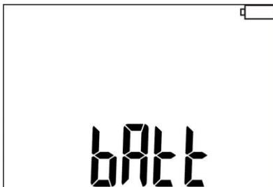
Akumulátory jsou téměř vybité, a dojde k zablokování měření. Měřič se automaticky vypne po 5 sekundách.
