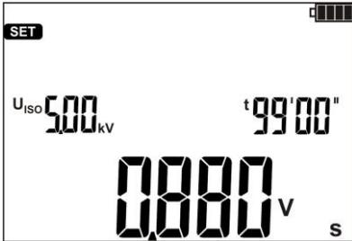
Nastavení měřicího času je možné v rozpětí od 5 s do 99 min. Nastavení hodnoty  $U_{ISO}$  a času měření umožňuje vypočítat tempo růstu napětí uvedeného v V/s. Rychlost růstu napětí je regulována od hodnoty 0,005 V/s (pro  $U_{ISO} = 50$  V a  $t = 99$  min) do maximální hodnoty 996 V/s (pro  $U_{ISO} = 5,0$  kV a  $t = 5$  s). V případě růstu rychlosti  $\geq 50$  V/s na měřiči se zobrazí symbol **FAST** a nezobrazí se hodnota změřeného odporu, pouze hodnota průrazného napětí.
