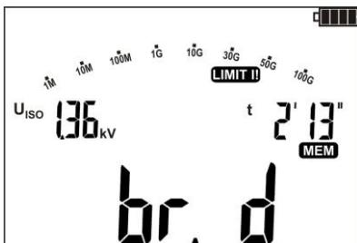
V případě, že dielektrická odolnost měřené izolace bude narušena a dojde k průlomu, na hlavním poli displeje se zobrazí informace br. d - breakdown.
