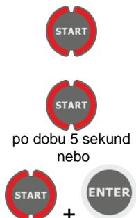
Stiskněte a přidržte tlačítko **START**. Měření je prováděno nepřetržitě až do chvíle uvolnění tlačítka nebo uplynutí naprogramovaného času.
