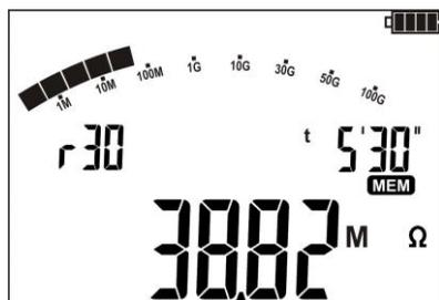
Hodnota odporu  $R_{ISO}$  měřená v čase  $t=5'30'$ . Symbol  $r_{30}$  označuje vybraný časový interval, ve kterém byla uložena hodnota odporu.
