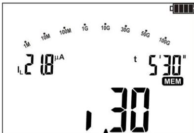
Hodnota svodového proudu  $I_L$  měřená v čase  $t=5'30''$ . Symbol  $I_{30}$  označuje vybraný časový interval, ve kterém byla uložena hodnota svodového proudu.
